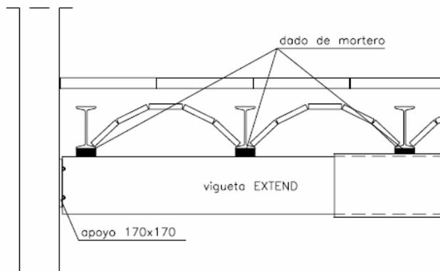
REFUERZO DE FORJADO DE VIGUETAS DE HIERRO A PARTE LUZ O VIGA RIÑONERA
