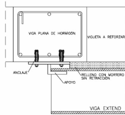
FIGURA 7. VIGA METÁLICA
